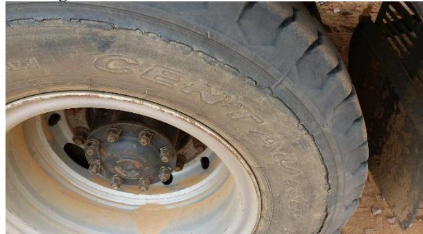
Foto 04: Veículo de placa PEX 7041: Pneu deteriorado; Serra Talhada/PE, 30 de agosto de 2017.
