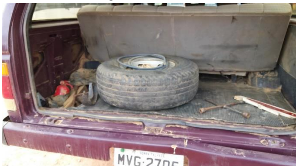
Foto 13: Veículo de placa MVG 2705: Pneu, ferramentas, extintor encontravam-se soltos no porta-malas, oferecendo perigo de serem arremessados contra os estudantes em caso de colisões e manobras bruscas;
