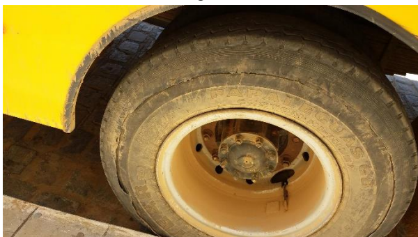
Foto 19: Veículo de placa PGG 3373: Pneu deteriorado; Serra Talhada/PE, 31 de agosto de 2017.
