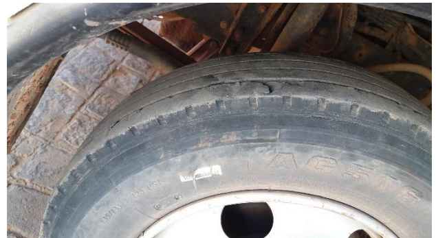
Foto 26: Veículo de placa LOV 4585: Pneu “careca” e deteriorado; Serra Talhada/PE, 31 de agosto de 2017.
