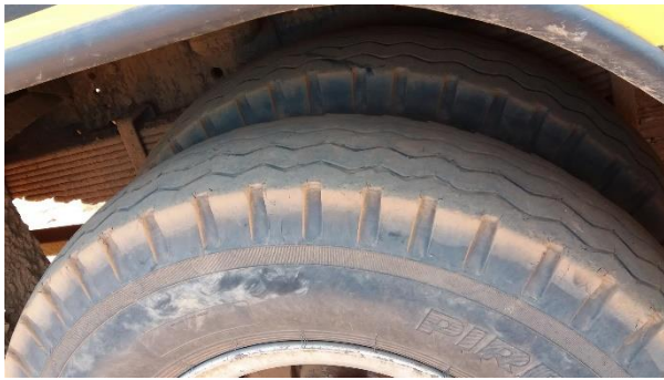
Foto 15: Veículo de placa PEX 7201: Pneus “carecas”; Serra Talhada/PE, 30 de agosto de 2017.
