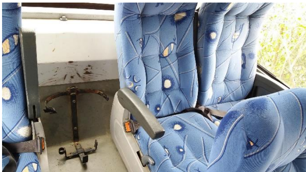
Foto 11: Veículo de placa PFJ 0222: peça de metal exposta, oferecendo perigo de lesionar os estudantes em caso de colisões e manobras bruscas; Serra Talhada/PE, 30 de agosto de 2017.
