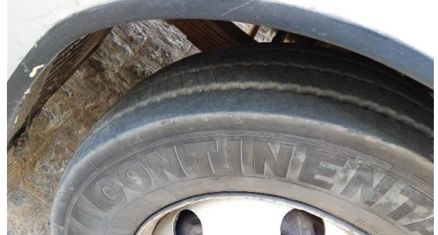
Foto 28: Veículo de placa PEL 0232: Pneu “careca”; Serra Talhada/PE, 31 de agosto de 2017.
