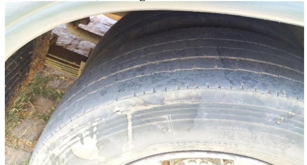
Foto 30: Veículo de placa KHM 8929; Pneu “careca” e deteriorado; Serra Talhada/PE, 31 de agosto de 2017.
