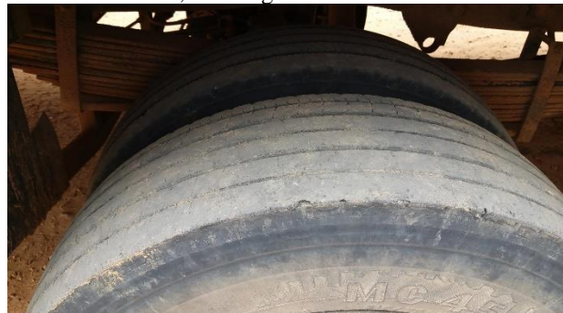
Foto 04: Veículo de placa PEX 7041: Pneu deteriorado; Serra Talhada/PE, 30 de agosto de 2017.
